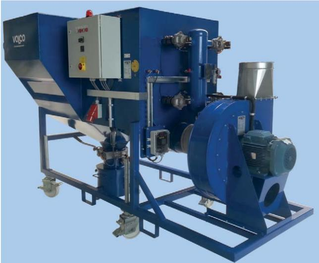
SAX-8-Mobil, auf Räder mit Feststellbremsen, für 4000 m³/h, mit 15 kW-Ventilator
