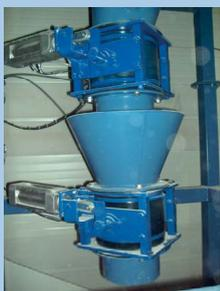
Filteranlagen können u. a. mit verschleißfesten Doppelaustragsklappen, Trogschnecken oder Zellenrad-schleusen in Standard- oder in ATEX- Ausführung ausgerüstet werden.
