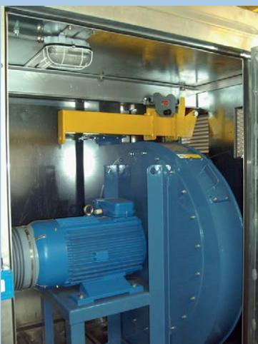
Schallschutzgehäuse mit Motorauszugs-kran und Beleuchtung
