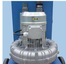
Seitenkanalgebläse Auf Schwingungsdämpfern montiert und durch Flex-Verbindungen mit dem Filtergehäuse verbunden.
