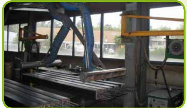
▼ 3 m Wirbelwindhaube montiert auf einer Werkbank.
