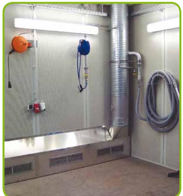
▲ Schleifkabine hier mit Bodensaugkanal und zusätzlich mit Injektorsaugsystem für Reinigungsarbeiten
