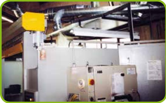
◀ Roboterabsaughauben in verschiedenen Ausführungen, z. B. mit Randabsaugung oder nur als Düsenplatte, speziell für den Kunden angepasst ▼
