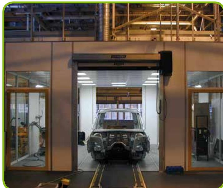
▲ Schleifkabine Automobilindustrie mit Absaug- und Zuluftsyttem
