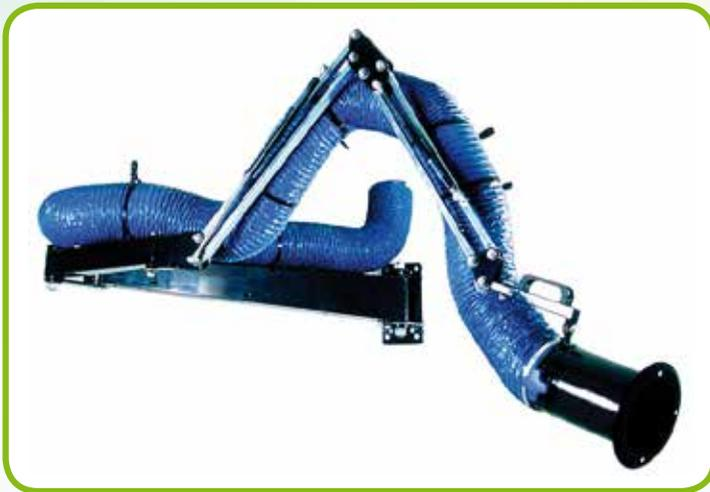
◀ Parallelogramm-Absaugarme in hoher Qualität, Längen von 1,5 – 10 m, Schlauchdurchmesser 45 – 200 mm. Die außen liegenden Gelenke und Gasdruckdämpfer sorgen für eine optimale Bedienung und für eine lange Lebensdauer.
