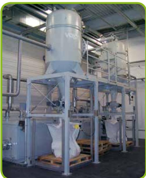
Zentrale Staubsauganlage in der Automobilindustrie, explosionsgeschützt, Volumenstrom 2000 m<sup>3</sup>/h bei 40 kPa Unterdruck.
