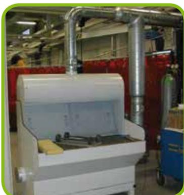
◀ Absaugtische mit Unterabsaugung, zusätzlich auch mit Oberabsaugung, mit spezieller Luftverteilung für eine optimale Erfassung der Schadstoffe.
