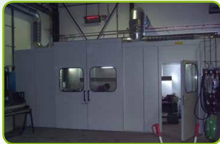
Schallschutzkabinen mit Absaugsystem für Schleifarbeiten, Strahlen- und Flamm-spritzarbeiten.
