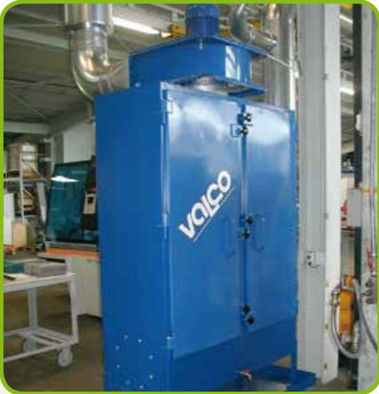
▼ Entstaubungsanlage mit Schlauchfilter für 40.000 m<sup>3</sup>/h, Stahlguss-Gießerei.
