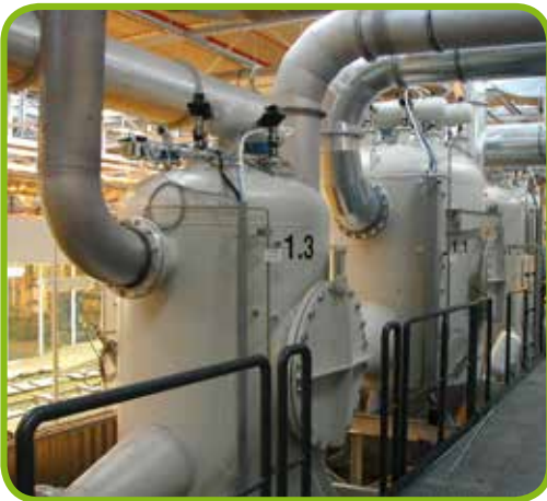
ATEX-Patronenfilter, 11 bar druckstoßfest für explosionsfähiges Pulver
