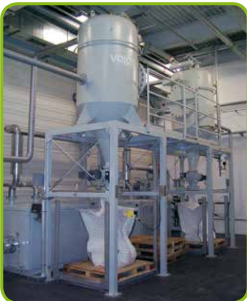
Zentrale Staubsauganlage für Pulverlacke, explosionsgeschützt, Volumenstrom 2000 m 3 /h bei 40 kPa Unterdruck.
