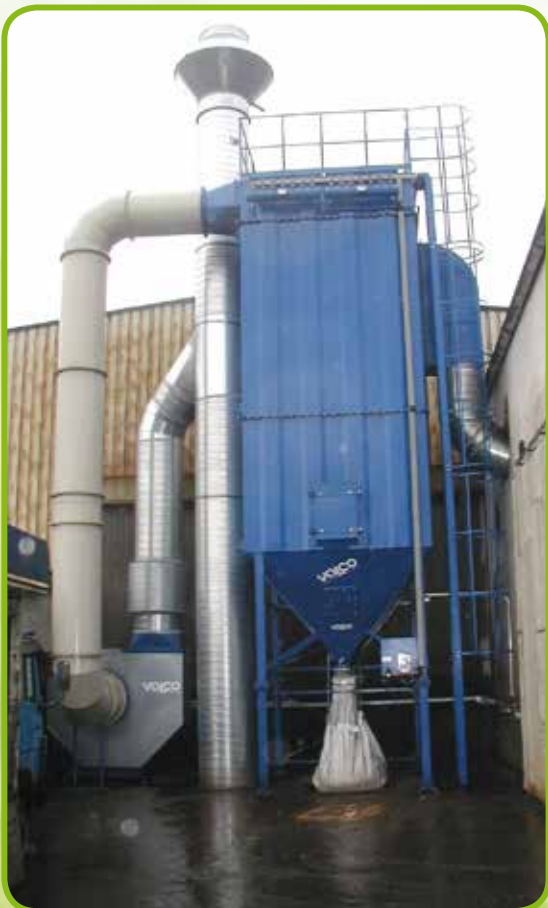
▼ Entstaubungsanlage mit Schlauchfilter für 40.000 m 3 /h, Stahlguss-Gießerei.
