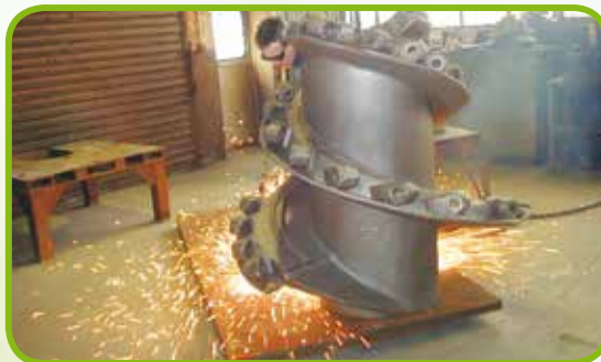
◀ Absaugtisch mit Wasserbad für Brennschneidarbeiten. In versch. Größen lieferbar.
